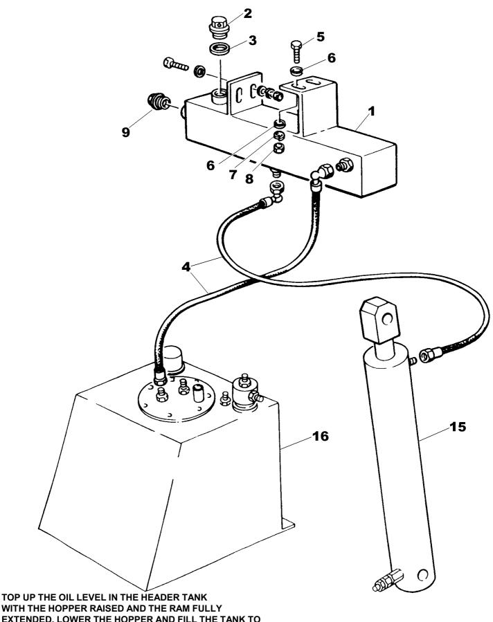
TOP UP THE OIL LEVEL IN THE HEADER TANK WITH THE HOPPER RAISED AND THE RAM FULLY EXTENDED. LOWER THE HOPPER AND FILL THE TANK TO BRNG THE LEVEL UP TO THE MIDWAY POINT ON THE SIGHT GLASS. THE LEVEL WILL RISE AS THE HOPPER IS RAISED AND DROP AS THE HOPPER IS LOWERED. THE LEVEL SHOULD ONLY BE CHECKED WITH THE HOPPER LOWERED.
