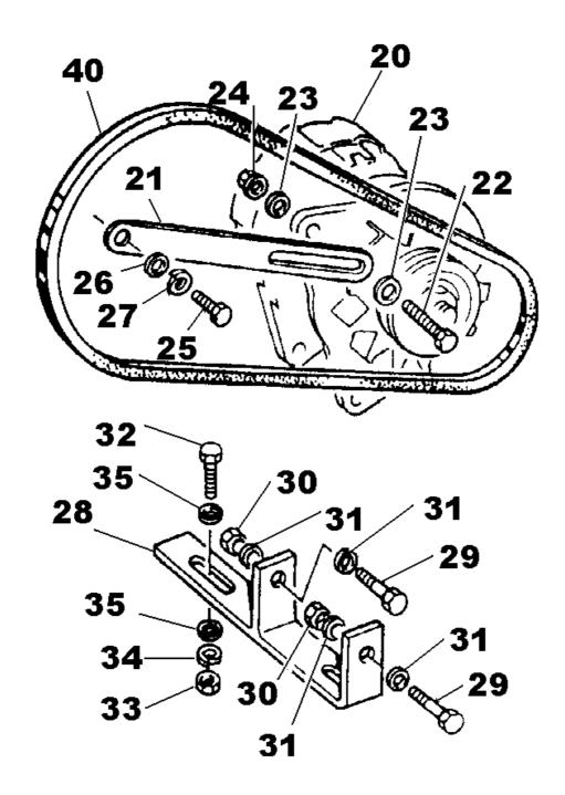
SECURE ALTERNATOR FAN AND PULLEY BEFORE INSTALLING ALTERNATOR, ADJUST DRIVE BELT TENSION SO THAT BELT DEFLECTS NO MORE THAN 12MM MIDWAY BETWEEN PULLIES. ADJUSTER ITEM 21 IS ATTACHED TO THE REVERSING GEARBOX.
