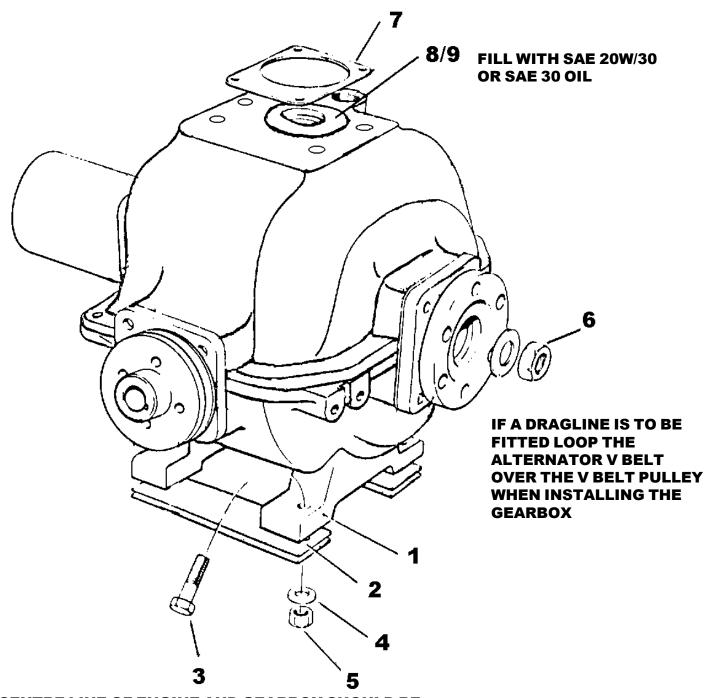
THE CENTRE LINE OF ENGINE AND GEARBOX SHOULD BE ADJUSTED USING SHIM PACK ITEM 2, AS REQUIRED. THE PLAIN NUTS ON THE DRIVE COUPLINGS SHOULD BE CHANGED TO SELF LOCKING NUTS, 192S07. THE SPLINED DRIVE NYLON SLEEVE SHOULD SLIDE FREELY ON THE DRIVEN & DRIVE SPLINED MEMBERS.
