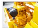
محرك ديزل Lister Petter مزود بالهواء يحتوي على ٢ أسطوانة وبه فلتر هواء بطروني
