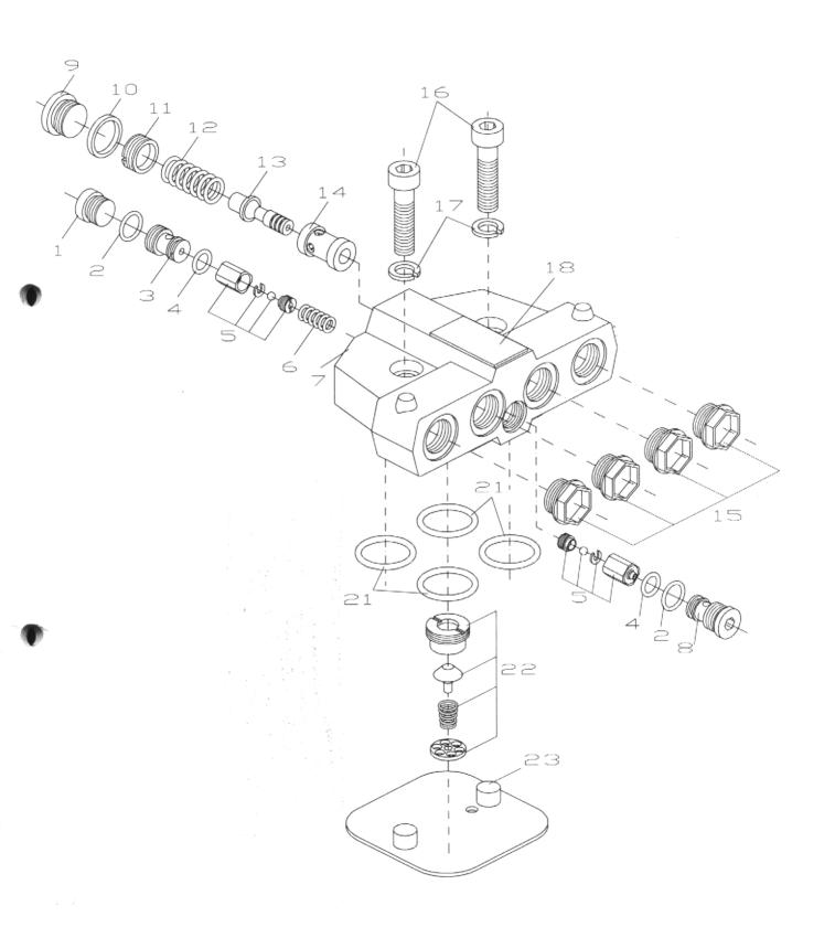
Valve Blocks BKH 1÷4 and BKHR, Service Manual Dismantling (ref. Item pos 1÷23 from exploded views see pages 4÷8) VENTILBLÖCKE BKH 1÷4 und BKHR, Service-Handbuch Reihenfolge der Demontage (gem.Pos.Nr 1÷23, Bild......, siehe Seiten 4÷8)
