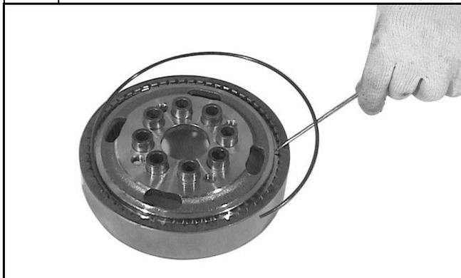
Rimuovere l'anello di arresto d'acciaio e separare il mozzo-fermo corona dalla corona epicicloidale.
