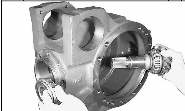
Inserire il gruppo pignone conico nella sede del corpo centrale ed il secondo cuscinetto sul codolo pignone. Eseguire il piantaggio del cuscinetto, utilizzando il battitoio (cod. CA715004) ed un martello. Si consiglia di contrapporre un'azione resistente alla forza battente (ad esempio con una mazza).
