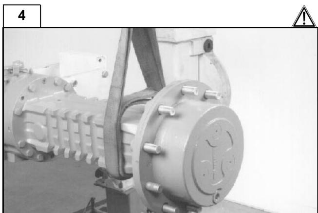
Disporre l'assale su supporti adatti a sostenere sia il corpo centrale che le due trombe, anche dopo la loro separazione, o assicurare i tre gruppi separatamente con funi o cinghie ad un sistema di sollevamento.
