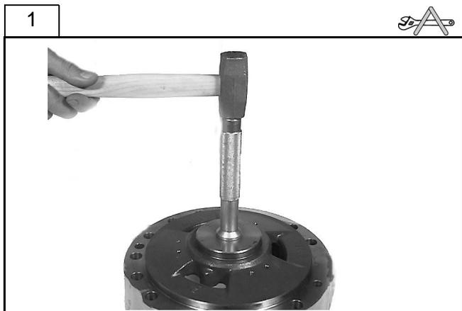
Posizionare la flange su di una superficie piana e piantare la pista esterna del cuscinetto a rulli conici con il battitoio (cod. CA715026), il manicotto intercambiabile (cod. CA119033) ed un martello.
