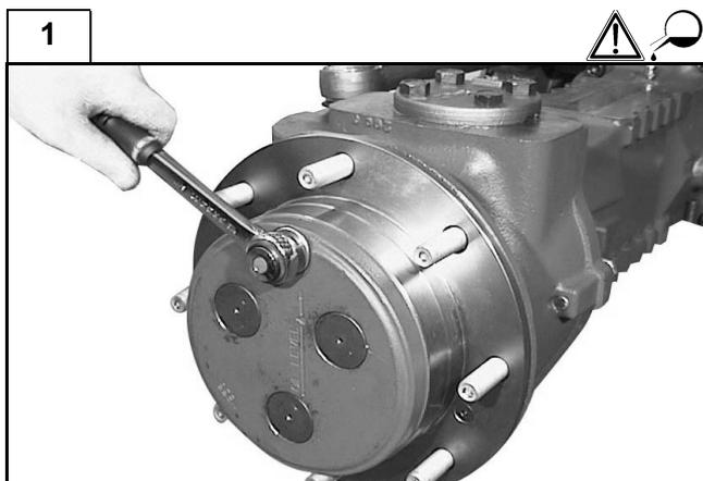
Prima di effettuare l'operazione di scarico dell'olio, posizionare il mozzo ruota con il tappo nel punto più alto e svisarlo di qualche giro per eliminare eventuale pressione interna, quindi rimuoverlo completamente. Ruotare il mozzo fino a portare il foro nel punto più basso. Scaricare completamente l'olio.
